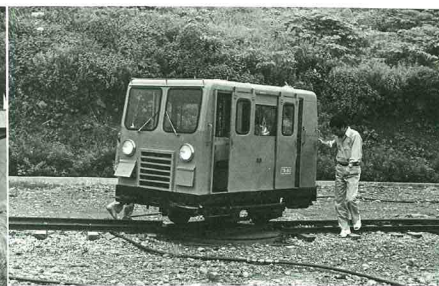
モーターカーは手押式の小きなターナブルで方向転換をする／'80.8
